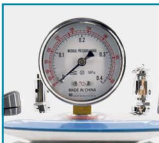
Los sistemas de "sobretemperatura" y "sobrepresión" garantizan el más alto nivel de seguridad durante el ciclo de funcionamiento.
