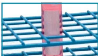
Los orificios cuadrados para el tubo y el diseño del fondo ranurado garantizan la sujeción firme de los mismos en las posiciones exactas.
