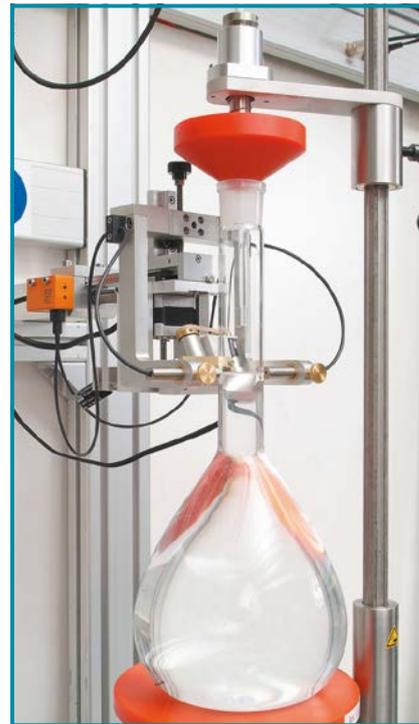
El llenado con agua de los productos en blanco se realiza automáticamente por las máquinas de calibración.
