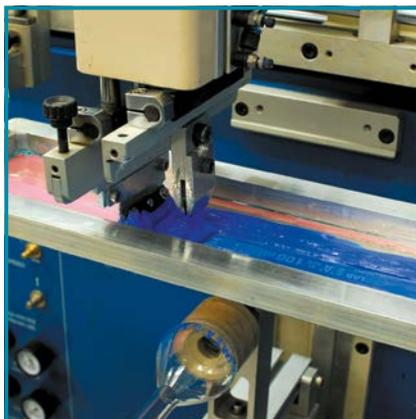
*Solo la impresión fina y con alto contraste permite una lectura precisa en aparatos con escalas, tales como cilindros, buretas, pipetas, etc.*
