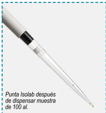
Punta Isolab después de dispensar muestra de 100  $\mu$ l.
