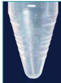
Las marcas de volumen precisas en el fondo del tubo muestran claramente y visualmente el volumen de líquido contenido en el fondo.
