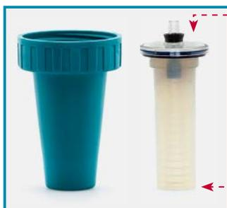
El filtro de PTFE hidrofóbico reemplazable de 0,45  $\mu\text{m}$  protege contra la contaminación cruzada.
