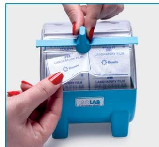
El parafilm se corta con un movimiento de la cuchilla de lado a lado.
