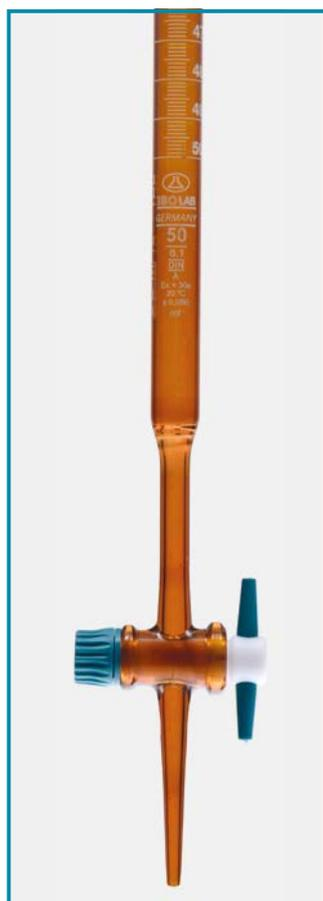
► Fabricado a partir de tubos de borosilicato calibrados previamente al vacío 3.3 de acuerdo con la norma ISO 385. Calibrado según la norma DIN / ISO Clase "AS".
