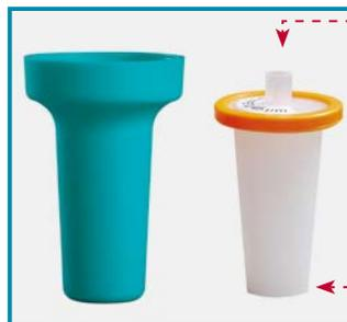
El filtro de PTFE hidrofóbico reemplazable de 0,45  $\mu\text{m}$  protege contra la contaminación cruzada.
