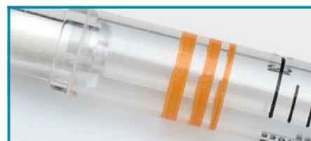
La identificación del volumen por la codificación de color en la pipeta permite una fácil identificación del volumen durante el trabajo.
