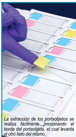
La extracción de los portaobjetos se realiza fácilmente presionando el borde del portaobjeto, el cual levanta el otro lado del mismo.
