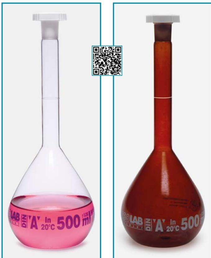
➤ Fabricado con vidrio de borosilicato 3.3 resistente al calor según la norma DIN EN ISO 1042. Calibrados por robots automáticos según la norma DIN/ISO Clase "A".
