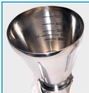
La graduación de volumen dentro de las paredes de los embudos permite una práctica indicación de volumen de la muestra.
