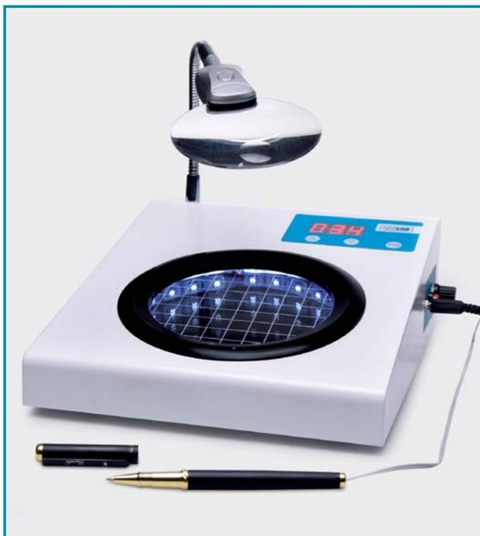
➤ Ideal para el recuento manual rápido y práctico de colonias sobre cualquier agar en placas de Petri. El versátil diseño exclusivo es apto para placas de Petri de 40 mm a 100 mm.
