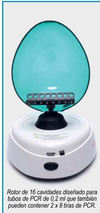
Rotor de 16 cavidades diseñado para tubos de PCR de 0,2 ml que también pueden contener 2 x 8 tiras de PCR.
