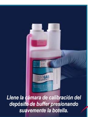
Llene la cámara de calibración del depósito de buffer presionando suavemente la botella.
