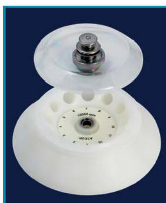
El rotor de plástico de alta resistencia con excelente balanceo permite una operación estable. Rotor de 12 cavidades diseñado directamente para tubos de 1,5 y 2,0 ml.
