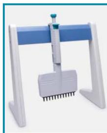
*El soporte lineal de micropipetas también puede contener pipetas multicanal.*
