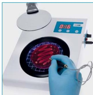
La marcación se realiza mediante un "lapicero con punta de fieltro" que está conectado al sistema mediante un cable.
