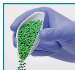
Con una ligera presión a los lados, los platos de pesaje se pueden convertir fácilmente en un embudo de vertido para una transferencia de muestras fácil y sin derrames.
