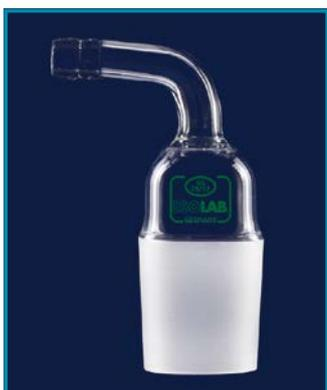
► Fabricado en vidrio de borosilicato resistente al calor y duradero, provisto con un adaptador de tubo con curva de 90°.
