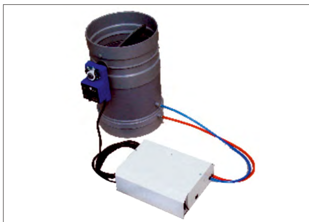
Controlador FC 500 + tubo de exaustão em PVC com sistema eléctrico de exaustão de abertura/fecho de borboleta através de tubos de medição de pressão de ar
